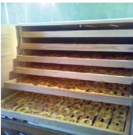
učitelj Branko Barić navodi kao jedini nedostatak nove sušare jer zrak sporije struji nego što je to slučaj sa starijom sušarom. Zamjenom drvenih rešetaka kromiranim taj će se nedostatak ukloniti i time povećati brzina i kapacitet sušenja. Još jedna sušara uvelike pridonosi potrebljama školske zadruge čiji voćari sada mogu sušiti jabuke brže i u većoj količini te ih tako brzo pretvarati u ukusan čips.
